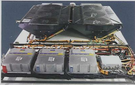
Componentes del Citaro G BlueTec® Hybrid
